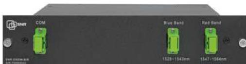
Оптический сплиттер используется для работы DWDM системы по одному оптическому волокну. Разделяет C-диапазон (1528..1565нм) длин волн на два поддиапазона: «Blue» (1528..1543нм) и «Red» (1547..1564нм), тем самым позволяет применять EDFA-усилители для DWDM-магистралей и в схеме включения по одному волокну. При этом на одной стороне используются оптические DWDM трансиверы из поддиапазона «Blue», а на другой из «Red»
