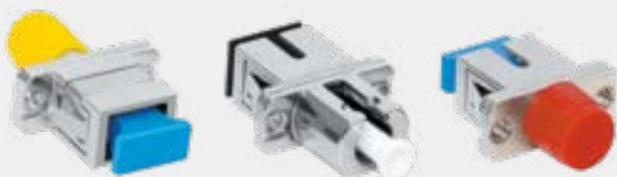
Оптические адаптеры имеют металлический или пластиковый корпус. Для надежной фиксации коннекторов используются стандартные для каждого типа разъемов фиксаторы, а пазы под «ключ» предохраняют феррулы соединяемых коннекторов от осевого сдвига.
