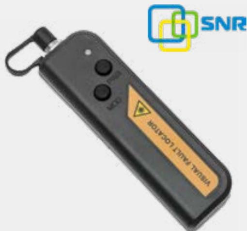
Визуальный дефектоскоп используется для контроля повреждений и дефектов в оптическом волокне. Для поиска дефектов используется сверхяркое излучение в видимом спектре (650nm – красный цвет). В результате места дефектов и повреждений во время теста светятся ярким красным светом. Режим мерцания обеспечивает видимость красного сигнала даже при ярком окружающем свете.
