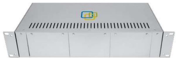
Второй блок питания является резервным (на случай выхода из строя основного). Стоит отметить, что в такие шасси устанавливаются медиаконвертеры с пропускной способностью от 100Мбит/с до 1Гбит/с. Все низкоскоростные конвертеры выполняют 2R-регенерацию сигнала:
