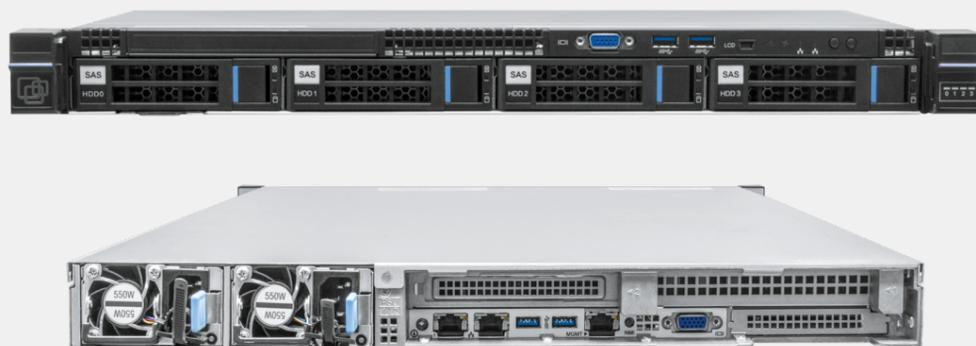
Универсальный компактный 1U высокопроизводительный сервер SNR-SR1204R. Предназначен для выполнения широкого спектра задач, построения серверов высокой вычислительной мощности, биллинга, баз данных (БД) и других ролей.
