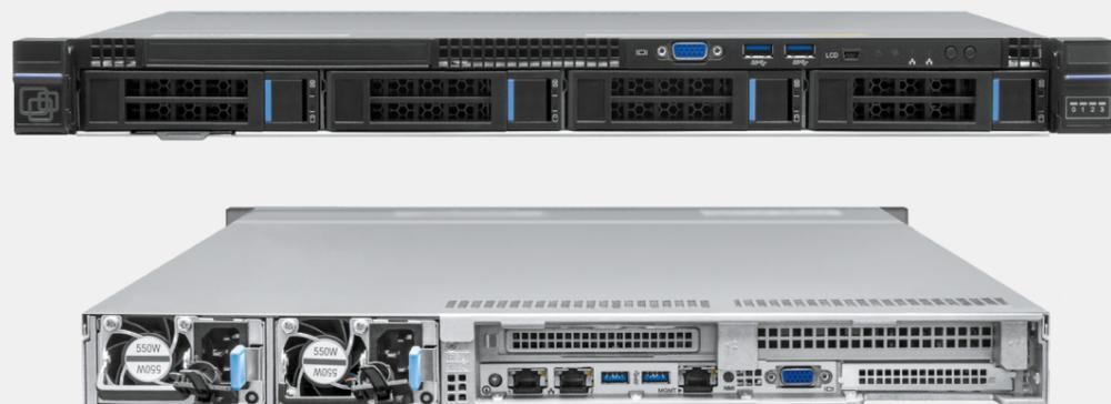
Универсальный компактный 1U высокопроизводительный сервер SNR-SR1204R. Предназначен для выполнения широкого спектра задач, построения серверов высокой вычислительной мощности, биллинга, баз данных (БД) и других ролей.
