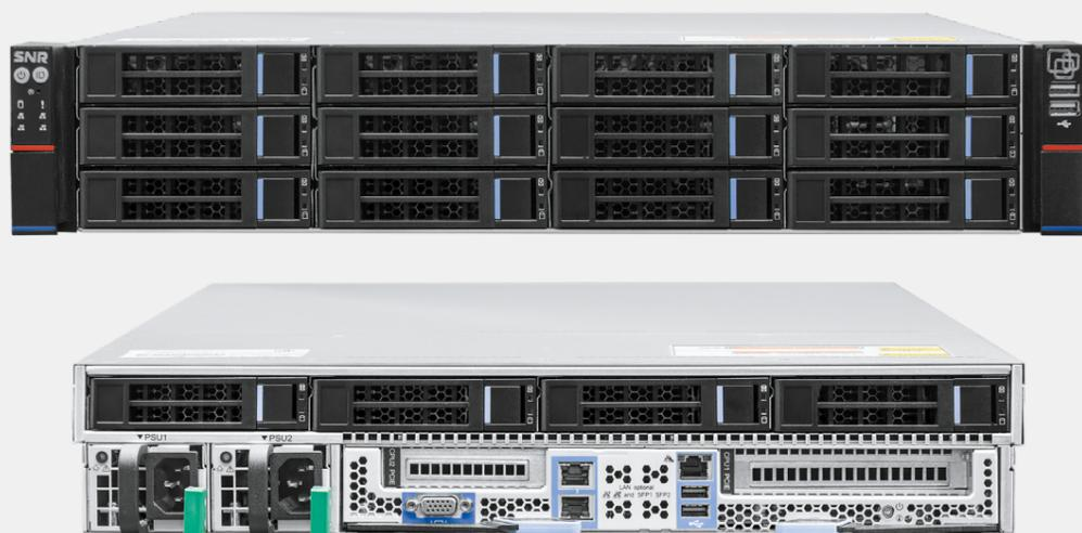
Сервер высокой дисковой плотности на базе процессоров Intel. Позволяет использовать до 16 жёстких дисков форм-фактора 2,5» или 3,5». Резервируемые блоки питания обеспечивают надёжную защиту от аварий.
